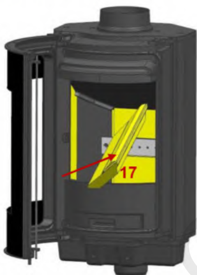
17: Insérer le réfractaire fond gauche à l'intérieur du corps.
