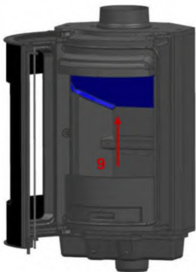
9: Maintenir le déflecteur dans le haut du corps avec la main pendant la mise en place des réfractaires.
