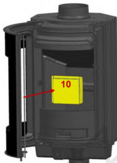
10 : Insérer le réfractaire bas à l'intérieur du corps.
