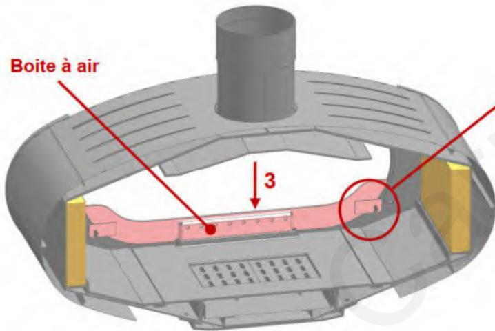
3 : Glisser les fentes dans les gougeons inox et serrer les écrous laiton.
