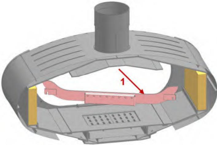
1 : Insérer le chenet (réf. 6811) en biais dans la chambre de combustion.
