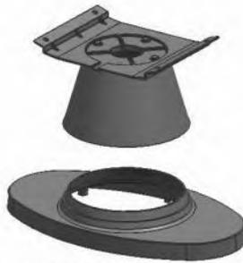
2 : Fixer le berceau (livré sur la chambre de combustion) sur la partie conique en fonte, puis poser l'ensemble sur la base du pied.
