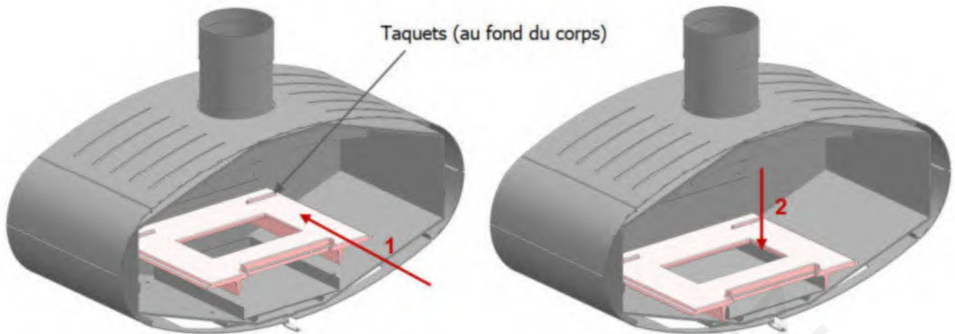
1 : Insérer la sole foyère dans la chambre de combustion
