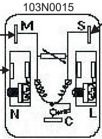
le plot S ne s'utilise que pour le raccordement d'un condensateur
